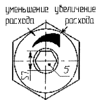
Рисунок А.15. – Габаритные и установочные размеры клапана КГЭЗ-100 с регулировкой расхода
