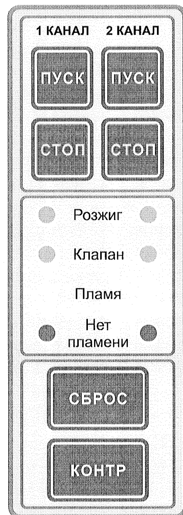
Рис.1 Панель управления прибора КРИК-2
